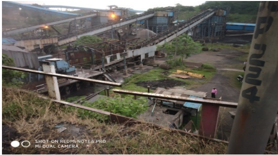
तस्वीर. 01: पैरा नंबर 4.6.1, तालिका संख्या 06, क्रम.सं.01: एमसीएल के लिंगराज खान में सीएचपी में अन कवर्ड कन्वेयर बेल्ट
